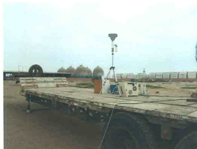
Fotografía N° 9: Estación de Monitoreo a Sotavento E2-S (LSDF). La misma que se encuentra en dirección NE de la zona de almacenamiento actual. El hecho de la ubicación sobre una plataforma es reducir los efectos del polvo presente por el paso de unidades durante el mantenimiento de las mismas, las cuales originan el levantamiento de Material Paticulado adicional
